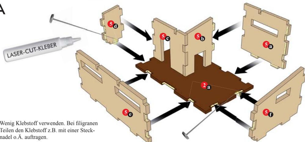
Wenig Klebstoff verwenden. Bei filigranen Teilen den Klebstoff z.B. mit einer Stecknadel o.Ä. auftragen.
